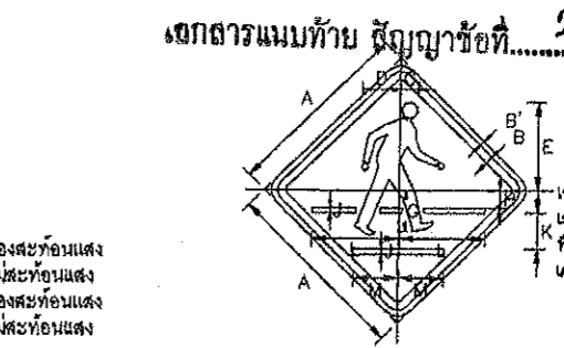
เว้นขอบป้าย สีเหลืองสะท้อนแสง เส้นขอบป้าย สีดำไม่สะท้อนแสง พื้นป้าย สีเหลืองสะท้อนแสง เครื่องหมาย สีดำไม่สะท้อนแสง
