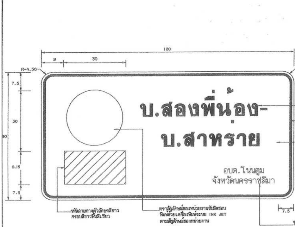
ป้ายหมายเลขทางหลวงท้องถิ่น น-1 (กรณีติดตั้งป้ายในเขตทางของทางหลวงท้องถิ่น หน่วยเป็น เซนติเมตร)
