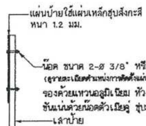
แสดงการติดตั้งป้ายบังคับ, ป้ายเตือน
